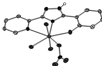
Рис. 2. Дані рентгено-структурного аналізу комплексу уранілу з похідним триазолу із одним кисневмісним замісником
